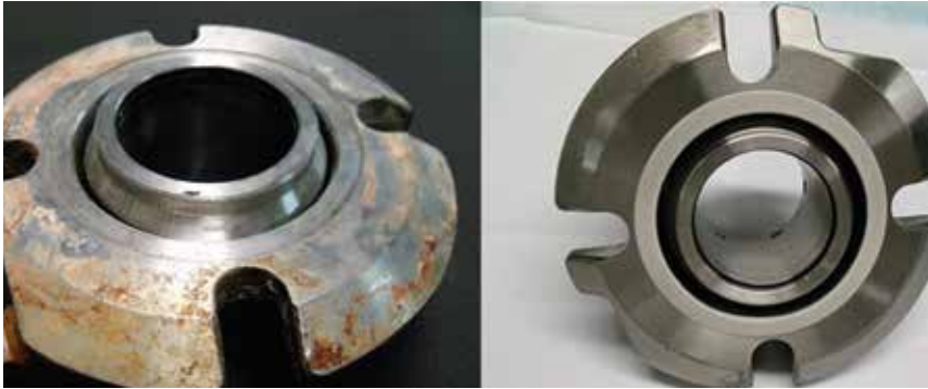
Cierre mecánico antes y después de la reparación
