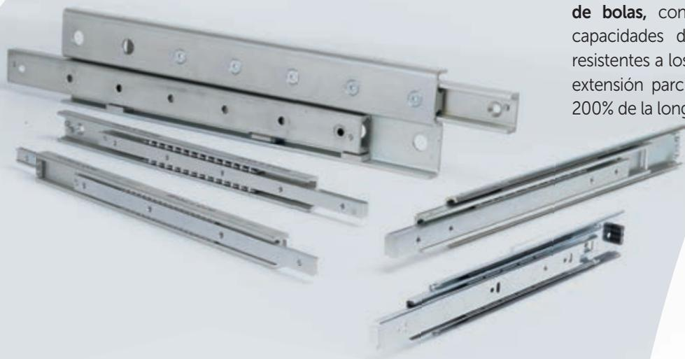
Guías telescópicas con rodamientos y jaula de bolas, con pistas de rodadura templadas, capacidades de carga elevadas, poca flexión, resistentes a los golpes y las vibraciones. Para una extensión parcial, total o extendida de hasta un 200% de la longitud de la guía.
